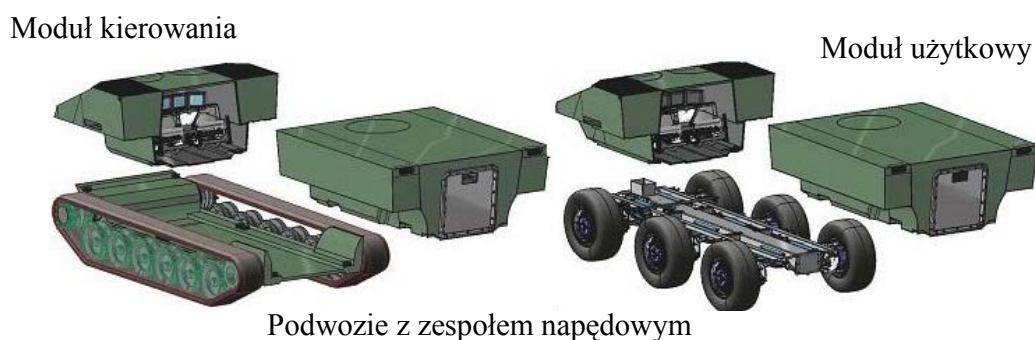
Rys. 1. Koncepcja rodziny pojazdów wg szwedzkiego projektu SEP B13 Fig. 1. The concept of vehicle family accord the Swedish project SEP B13
