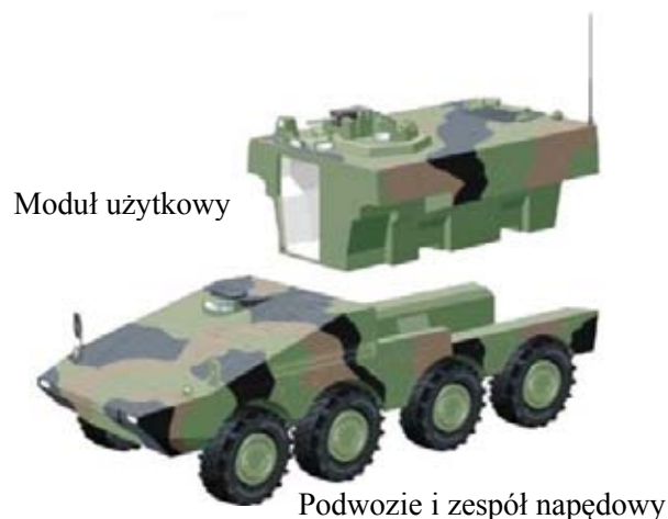
Rys. 3. Modułowa budowa pojazdu Boxer Fig. 3. Modular structure of the Boxer vehicle
