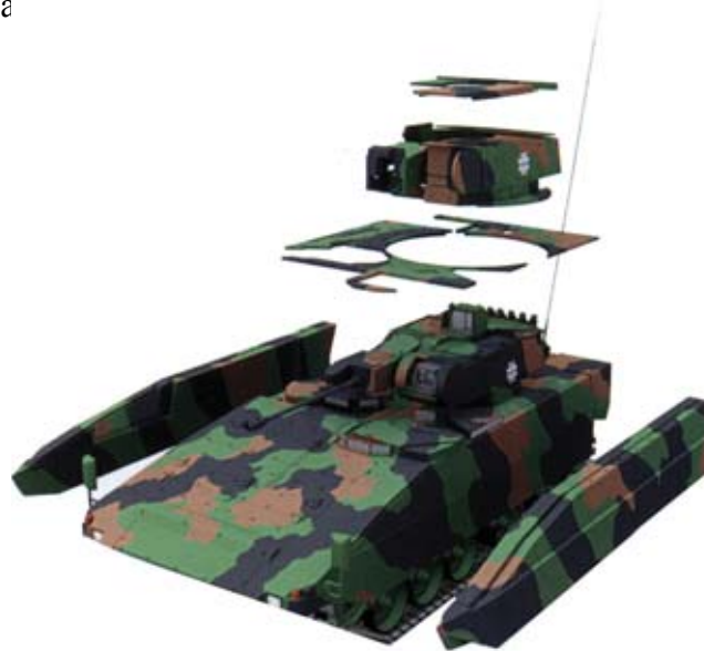
Rys. 9. Dopancerzenie modułowe pojazdu PUMA Fig. 9. The Additional modular armour for PUMA vehicle
