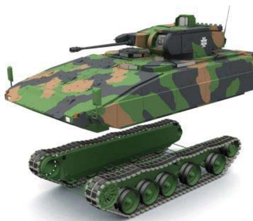
Rys. 8. Zintegrowane moduły gąsienicowe pojazdu PUMA: a - przekrój zespołu jezdnego, b - widok pojazdu i dwóch modułów zespołu jezdnego
