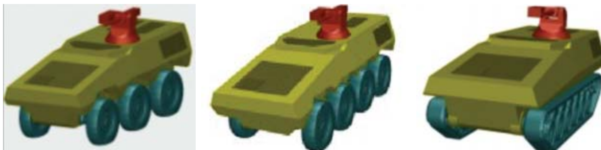
Rys. 7. Koncepcja unifikacji francuskich pojazdów opancerzonych klasy 20 ton (EB20IS) Fig. 7. The concept of unification of French armoured vehicles class 20 ton (EB20IS)
